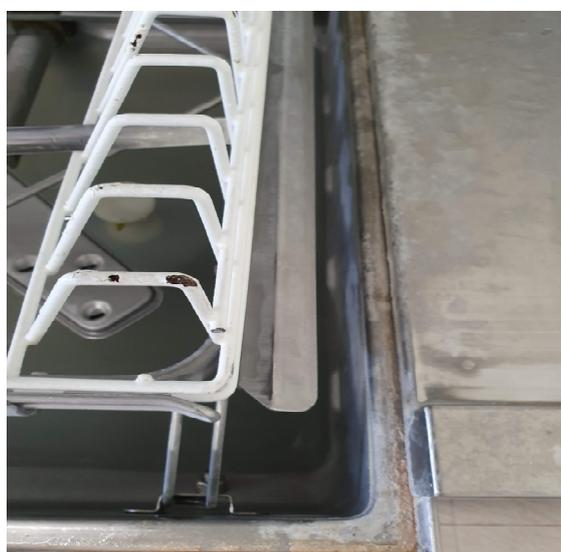
La lavastoviglie necessita un intervento di disincrostazione e la sostituzione del supporto porta piatti poichè il rivestimento distaccato in alcune parti evidenzia la base ferrosa arrugginita
