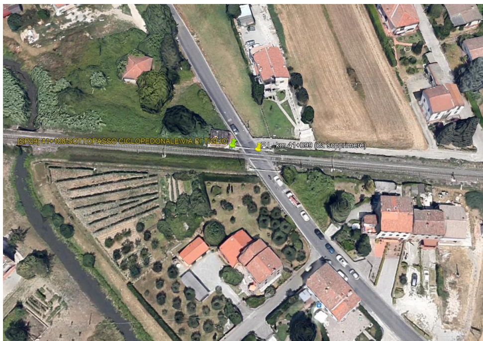
Figura 1-1 Vista satellitare del passaggio a livello al km 41+099 da sopprimere e del nuovo sottopasso pedonale al km 41+108
