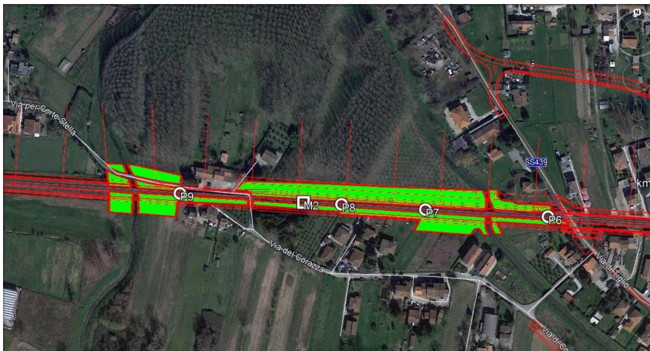
Figura 4.9 Dettaglio della collocazione degli attraversamenti faunistici presso il km 42 del tracciato in progetto: sono riportati i sottopassi di dimensioni medio-piccole (cerchi) medie (quadrati). In rosso è riportato il tracciato in progetto, in verde le aree destinate ad opere a verde.
