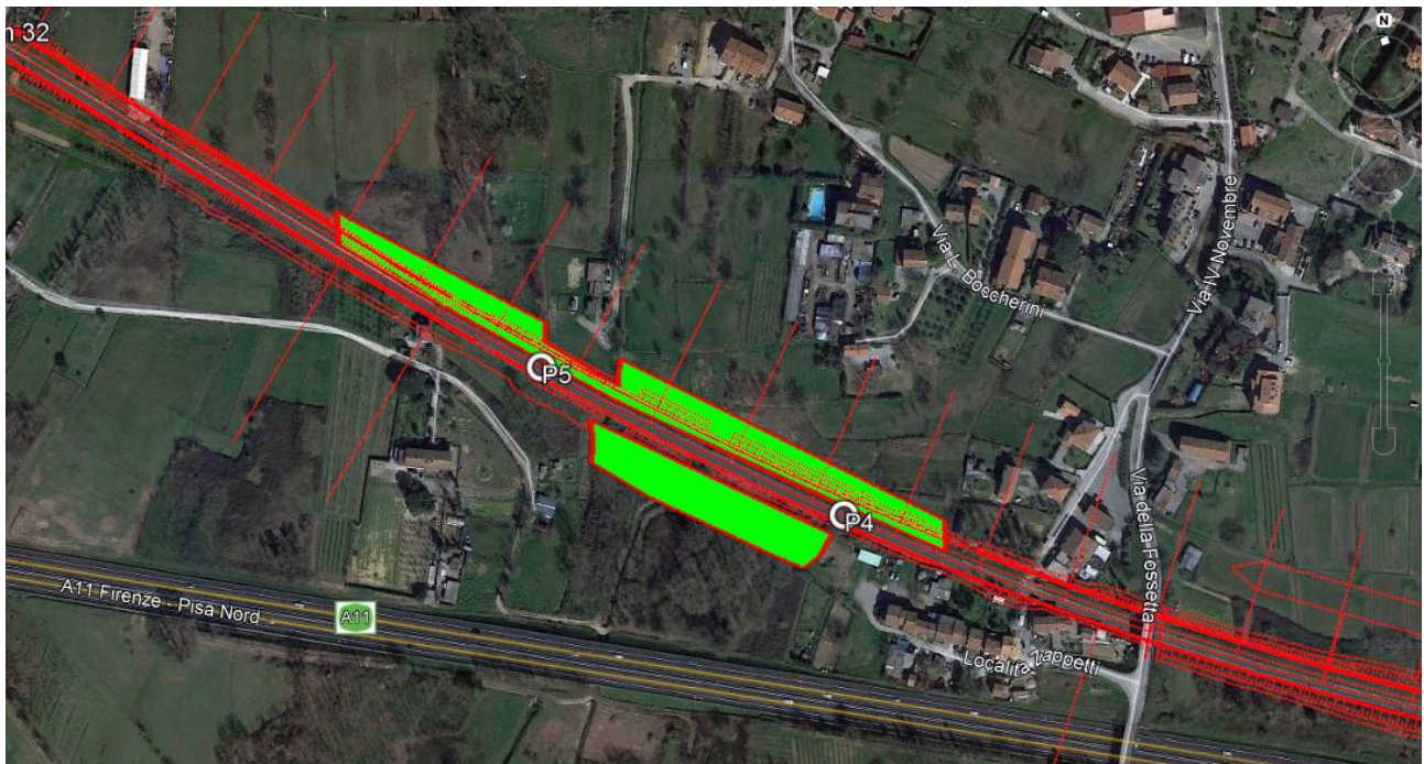
Figura 4.15 Dettaglio della collocazione degli attraversamenti faunistici presso il km 32 del tracciato in progetto: sono riportati i sottopassi di dimensioni medio-piccole (cerchi). In rosso è riportato il tracciato in progetto mentre in verde sono rappresentate le aree destinate ad opere a verde.
